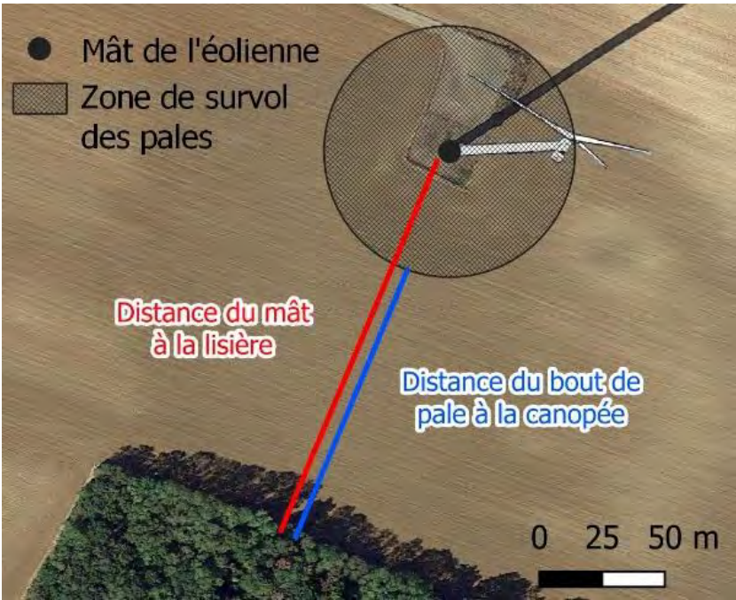
Figure 55 : Mesure des distances entre les éoliennes et les haies et boisements.
